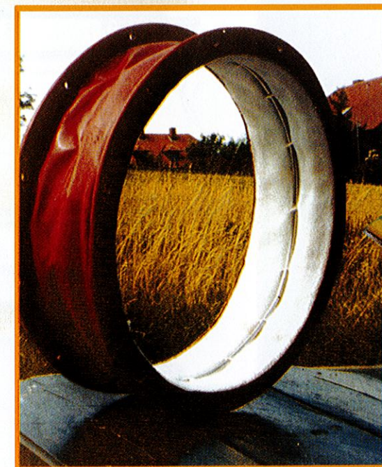
Mehrlagenkompensator als Saugstützen für Ventilator (mit Stützring gegen Unterdruck)
